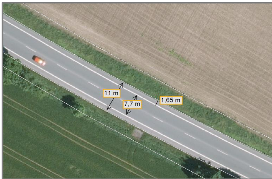
Abbildung 12: Bielefelder Straße L 785 mit Mehrzweckstreifen und Abmessung
