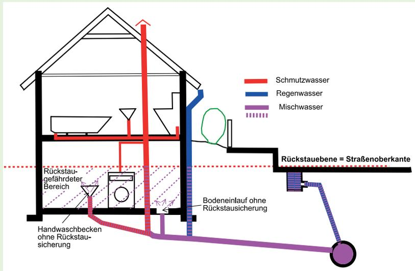
Beispiel eines Rückstaus aus dem Mischwasserkanal
